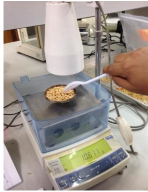
Gambar 2. Pengukuran kadar air menggunakan infrared
