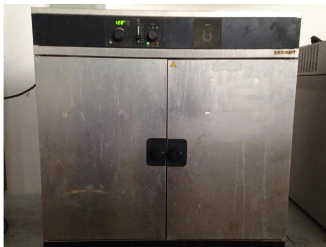
Gambar 1. Metode AOAC menggunakan oven kering
