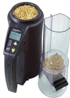
Gambar 3. Moisture meter tipe kapasitansi (Gac Meter)
