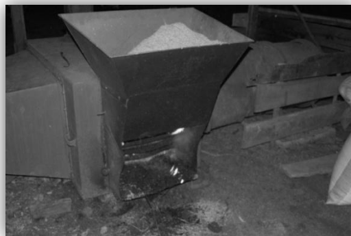
Gambar 3. Tungku pengering berbahan bakar sekam
